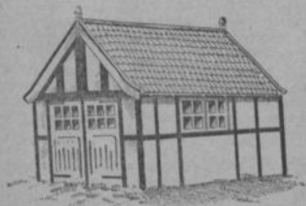
Рис. 1. Деревянный щитовой гараж. Крыша шиферная или черепичная (могут быть применены и другие новые строительные материалы); основание здания — деревянные столбы. Гараж может быть изготовлен с металлическими скрепляющими угловыми рамами
