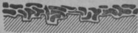
Рис. 2. Схематический разрез покрытия. Отдельные частицы сцеплены друг с другом механически
