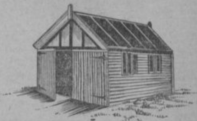
Рис. 2. Досчатый обшивной гараж. Крыша—толевая, асбестовая или шиферная; фундамент — деревянные бруслья; двери—створчатые
