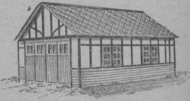
Рис. 4. Гараж щитовой секционной конструкции, обитый асбестовыми листами с огнестойкой покраской. Крыша шиферная или из других новых стропильных материалов. Гараж снабжен металлическими скрепляющими угловыми рамами
